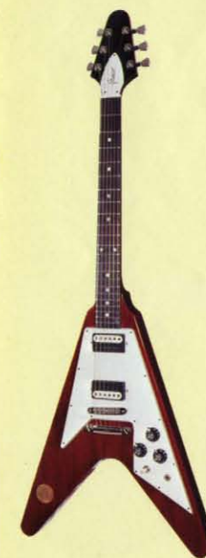
FV900 ..... ¥90,000 指板・エボニー ネット・マホガニー ボディ ・マホガニー 指板 セットネック ウォールナット 仕上げ ツットンカラーの2オリジナルスーパー ハンパッキングピックアップ 2V・1Tコン トロール付 スイッチクラフト社製3回路切替 トグルスイッチ キアソンXL弦使用 レギュラーケース ¥12,000
