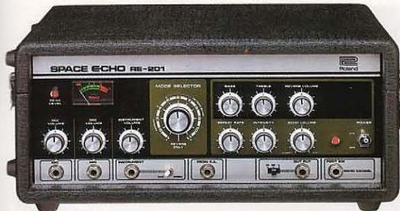
リバーブを含む12種のモードを備えており、リピーター、インテンシティ、エコー・ボリュームの各コントロールの組み合わせで豊かなエコー・サウンドが得られます。トリプル・ベースのコントロールはエコー音のみにはならず、原音を変えることなく自由にエコー音の音質調整ができます。また、電気ギターなどメーターでは表示できない立上りの早い衝撃音のピークが検出できる発光ダイオードのピークレベル・インジケーターが付いているなど
