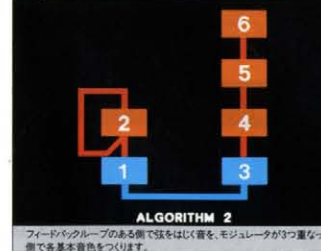
フィードバックループのある側で弦をはじく音を、モジュレータが3つ重なった側で基本音色をつけます。
