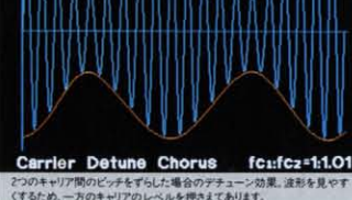
2つのキャリア間のピッチをずらした場合はデチューン効果。波形を見やすくするため、一方のキャリアのレベルを押し下げられています。
