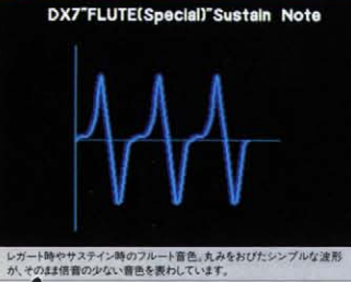
レガード時やサステイン時のフルート音色。入みをひいたシンプルな波形が、そのほほ音の少ない音色を表わしています。
