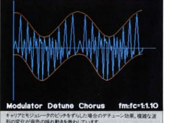
キャリアとモジュレータのピッチをずらした場合デチューン効果。複雑な波形の変化が音色の揺れ動きを表わしています。
